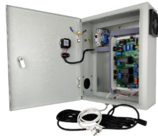
Шкаф питания на 1 ЭПРА
